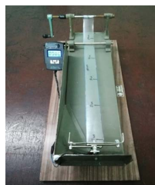
1-рукоятка; 2-опора; 3-мерная шкала; 4-образец растяжения; 5-тензодатчик
