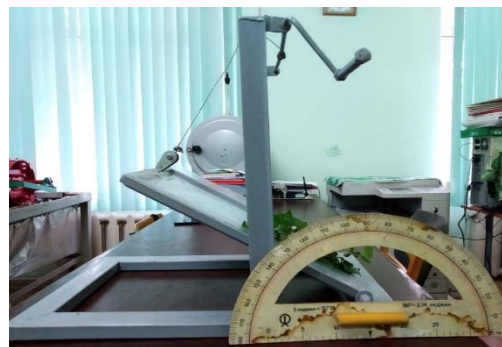
1-стальной лист; 2-станина горизонтальная; 3-вертикальная опора; 4-конечный блок; 5-промежуточный блок; 6-секторный механизм; 7-нить для привода стального листа.
