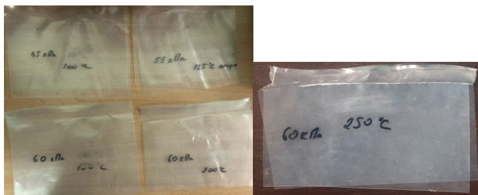
Рис. 3 – Образцы полиэтиленовой пленки с термосваренными швами при разных температурах.
