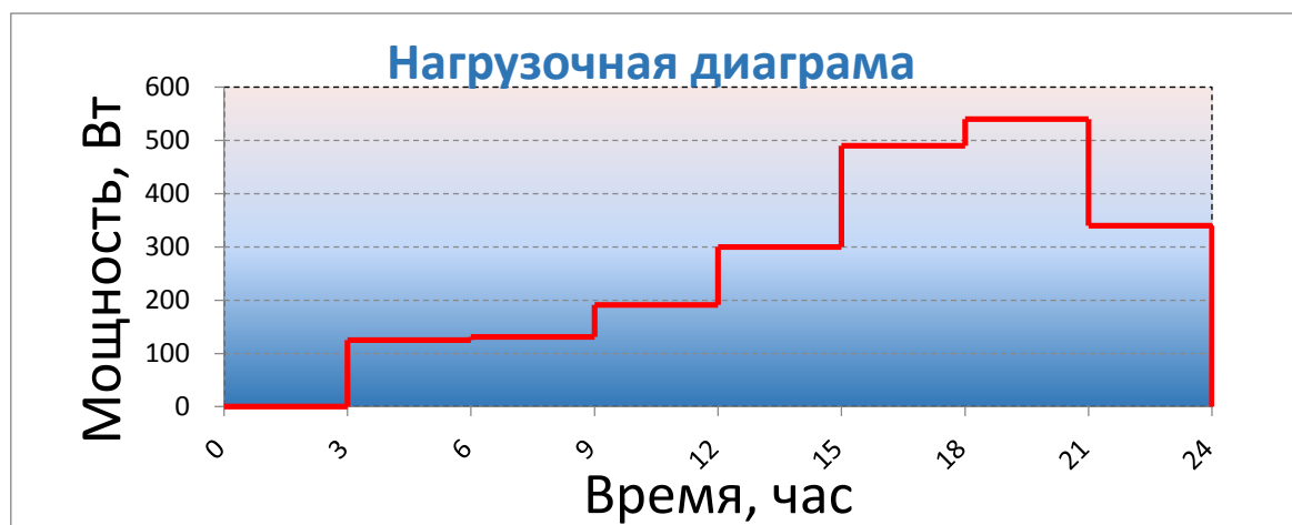
Рисунок 1 – Нагрузочная диаграмма суточного электропотребления
