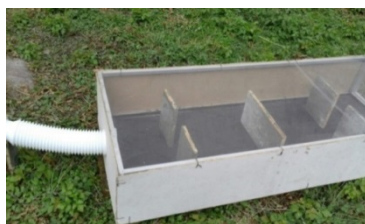
Рисунок 4. Общий вид дополнительного гелиоколлектора
