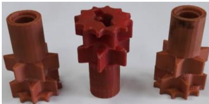
Рисунок 3 - Желобчато-катушечные высевальные аппараты с параболическими желобками
