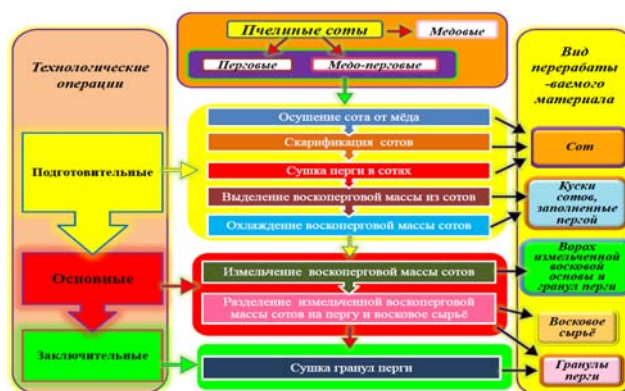
Рис. 1 – Схема технологического процесса промышленной переработки пчелиных сотов на пергу и восковое сырьё.
