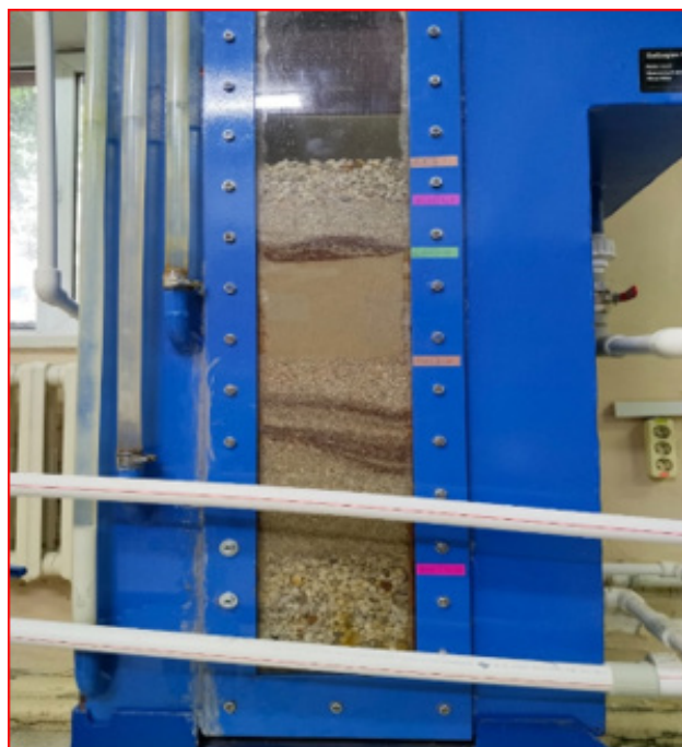
Сур. 3. Кварц жүктемесі бар №1 сүзгі [авторлық жұмыс]. [Fig.3. Filter №1 with Quartz load [author's work].].
