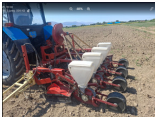
Рис. 5. Экспериментальный образец сеялки СТВ-2,4 в работе. [Fig7 5. Experimental Prototype of the STV-2.4 Seeder in Operation]
