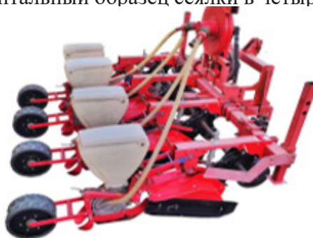
Рис. 4. Экспериментальный образец сеялки точного высева для сахарной свеклы
