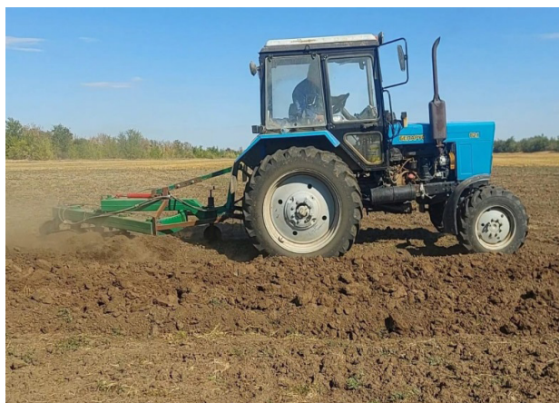
Рис. 2. Фрагмент производственных испытаний четырехкорпусного навесного плуга с ромбовидными рабочими органами
