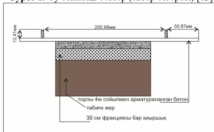
Сурет 2. Су өткізбейтін беттер (автор өзгертті) [13]
