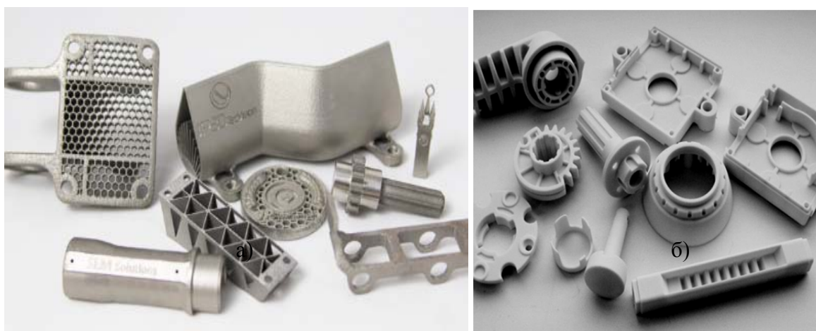
Рисунок 2 – Аддитивное производство запчастей Наборы запчастей из металла (а) и пластика (б)
