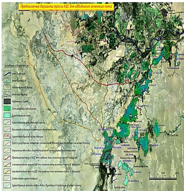
Рисунок 4 - Предлагаемые варианты трассы главного коллектора для обводнения «Зеленого пояса»
