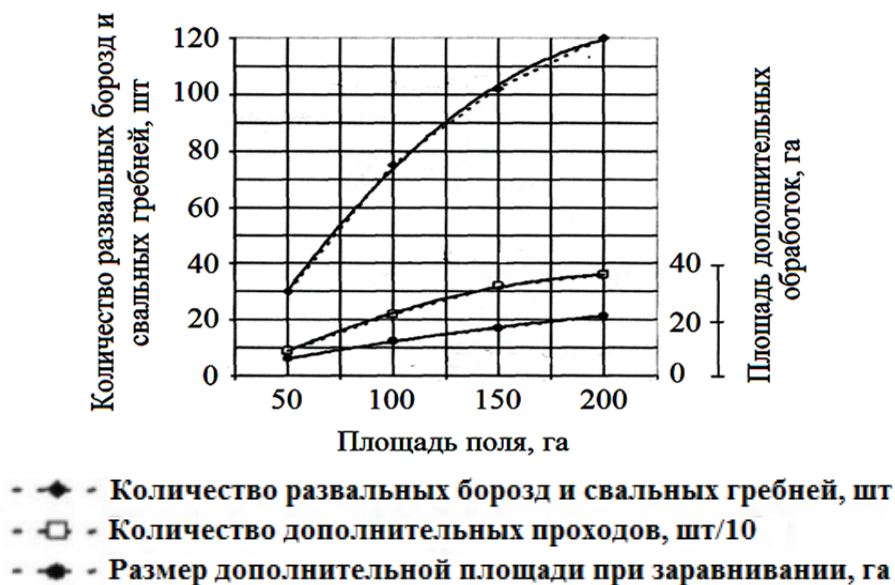
Рисунок 3. Изменение количества развальных борозд и свальных гребней ( K_{pz} ), дополнительных проходов ( K_{до} ) и дополнительной площади при разравнивании ( F_{до} ) в зависимости от площади поля ( F ).
