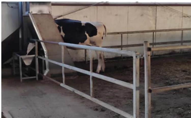
Рисунок 1 – Система контроля живой массы крупного рогатого скота
