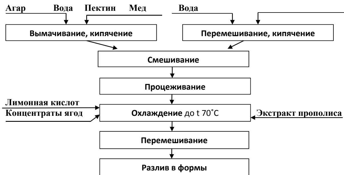
Рисунок 1 - Технологическая схема процесса приготовления медового желе «Пчелка»
