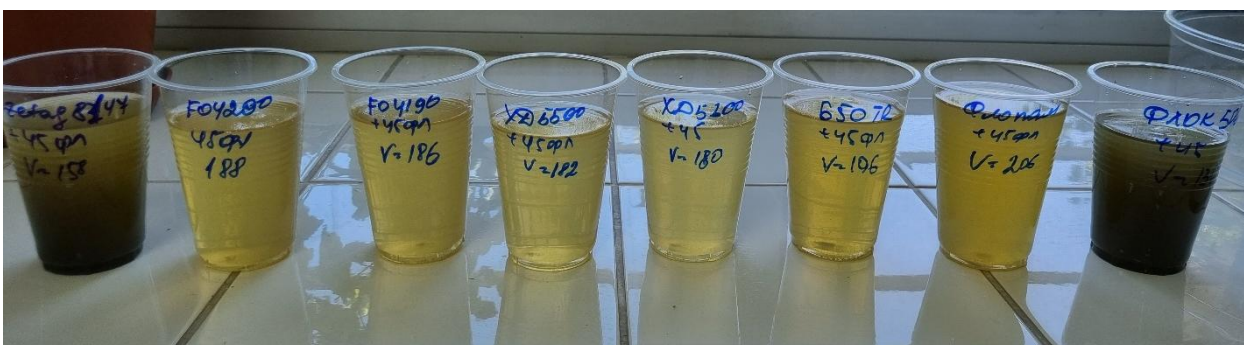
Рисунок 10 - Качество фугата после определения водоотдачи через сито при объеме добавленного флокулянта 45 мл.
