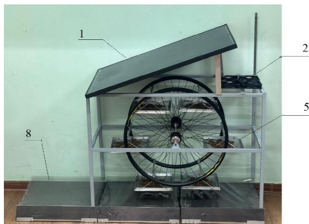
Рисунок 6 – Схема сушильной установки для гранул перги
