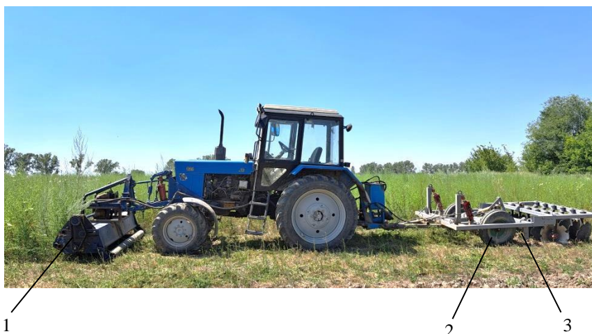
Рисунок 4 – Экспериментальный образец комбинированного орудия. 1-мульчирователь; 2 – чизельные рыхлители; 3-вырезные диски
