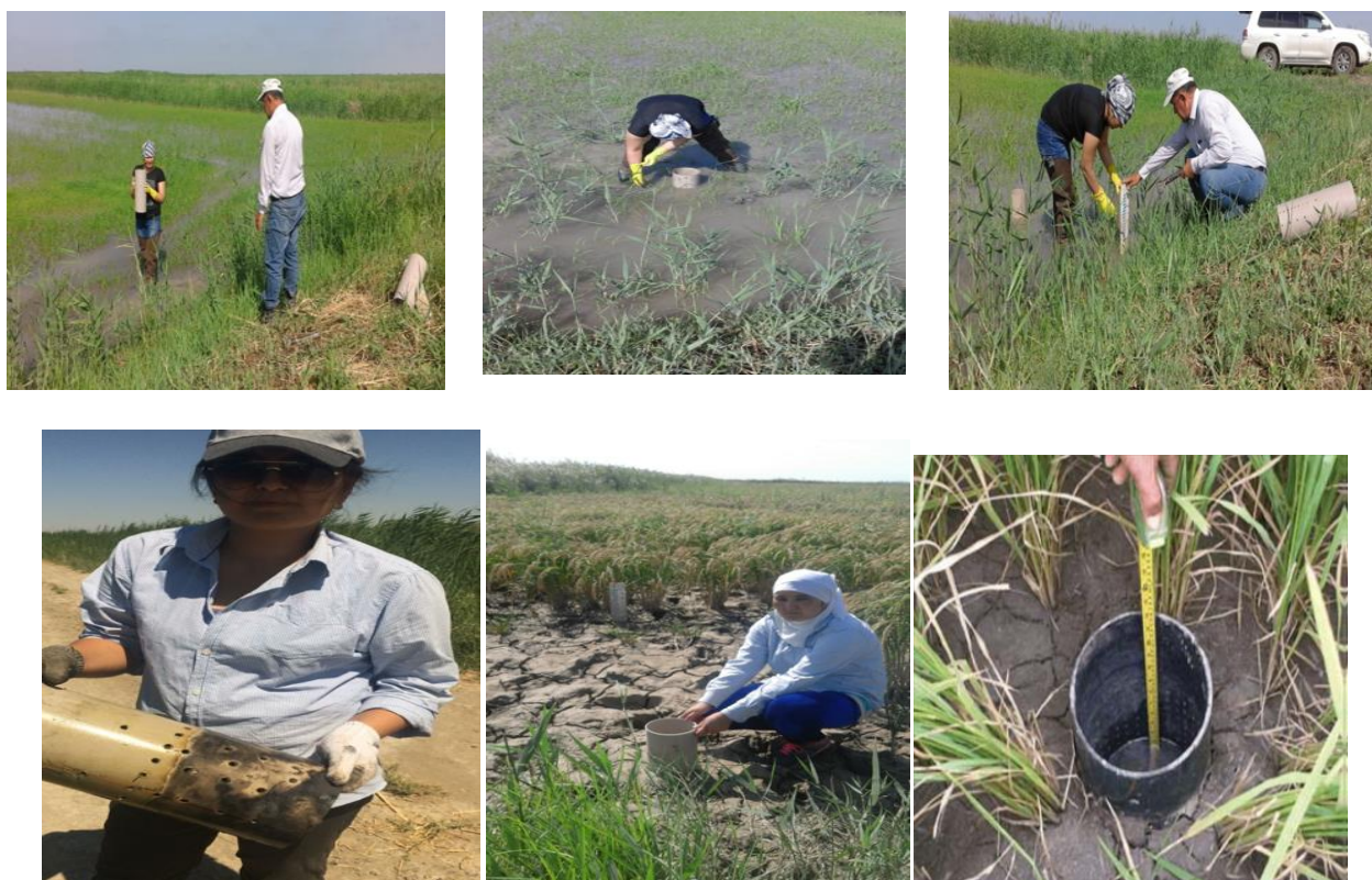
Рисунок 3- Укладка перфорированной трубы
