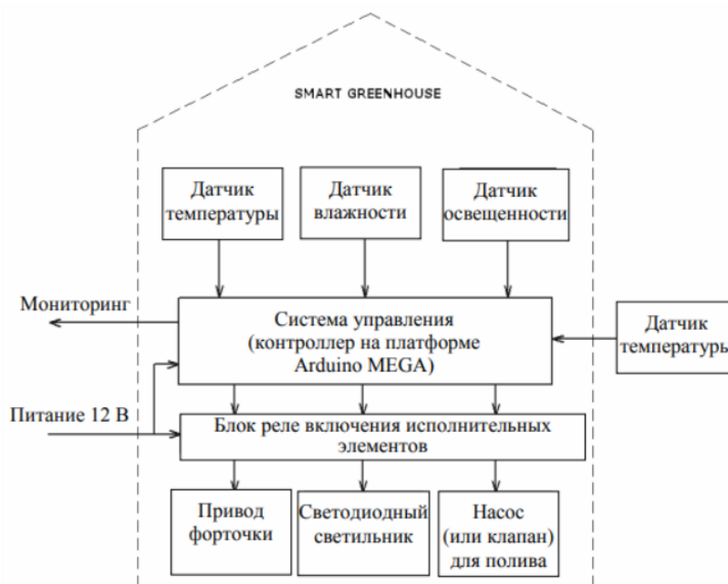
Сурет 3. Ферма жылыжайының микроклиматын автоматтандыру схемасы.
