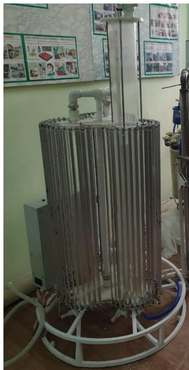
Рисунок 2 – Установка по получению суспензии хлореллы
