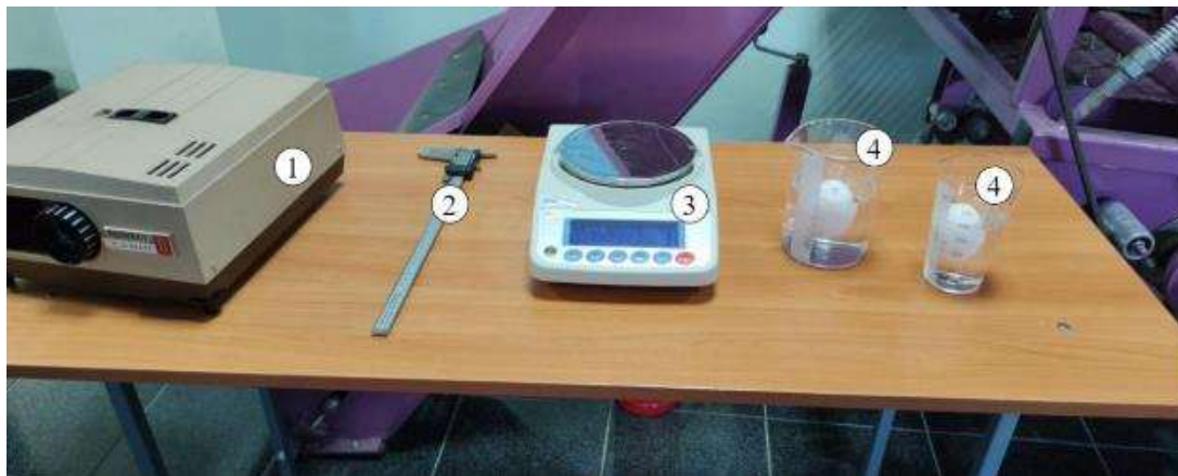
1 – Овоскоп (Проектор); 2 – Штангенциркуль; 3– Электронные весы; 4 – Мерные стаканы.
