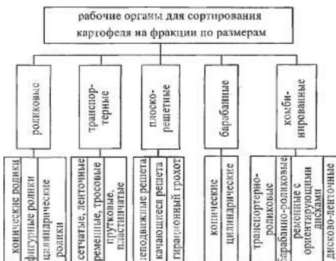
Рисунок 3 - Классификация рабочих органов для сортирования картофеля.
