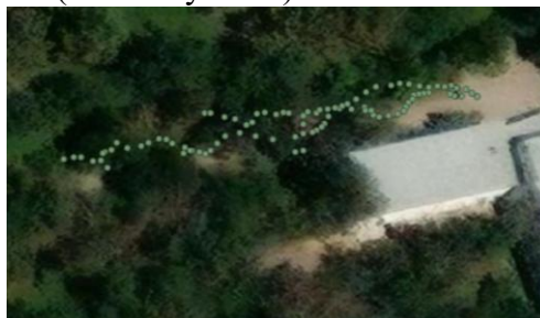
Рисунок 7 - Тест алгоритма управления устройством по сигналу GPS-трекера, запуск двигателя каждые 5 метров.
