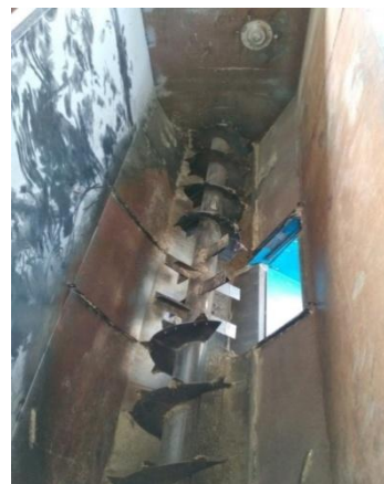
Рисунок 2 – Общий вид горизонтального шнека
