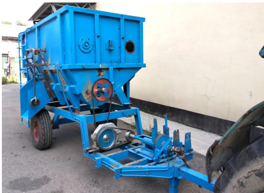
Рисунок 3 – Изображение общего устройства привода механизма горизонтального шнека
