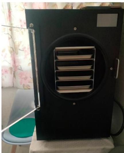
**Рисунок 1** - Внешний вид установки «Аламан-1», которая состоит из герметичного цилиндра, котором размещен сублиматор и десублиматор.
