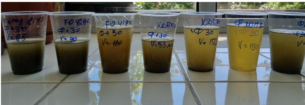
Рисунок 9 - Качество фугата после определения водоотдачи через сито при объеме добавленного флокулянта 30 мл.
