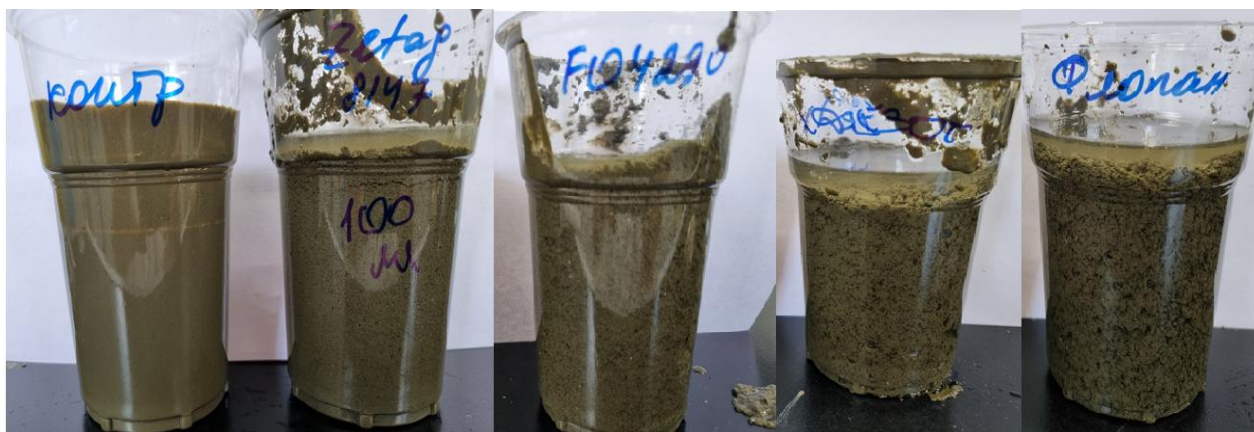
Рисунок 3 - Осадок после перемешивания с флокулянтами Zetag 8140, SNF Flopam FO 4290 SSH, Super floc XD 5300, Flopam AN 913 SH
