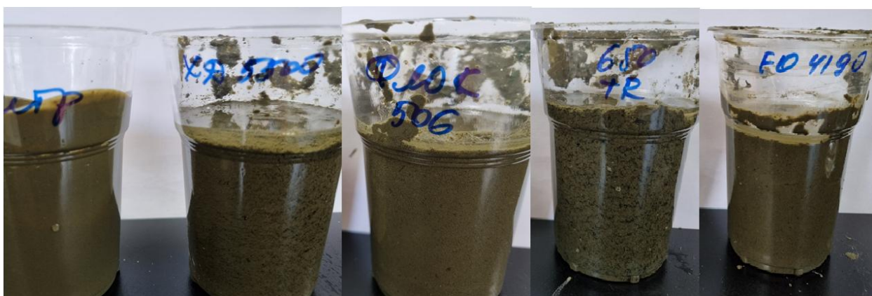
Рисунок 4 - Осадок после перемешивания с флокулянтами Super floc XD 5500, Русфлок 506, Praestol 650 TR, SNF Flopam FO 4190 PWG
