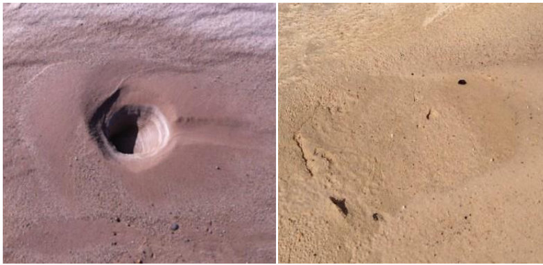
Сурет 6б - Ферментпен өңделмеген жер қыртысының көрінісі Сурет 6с - Ферментпен өңделген жер қыртысының көрінісі
