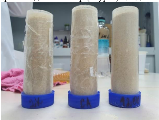
Сурет 2- Нығайтылған құм бағанының үлгісі
