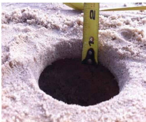
Сурет 6а- Сынақ алаңындағы цементтелген құмның қалыңдығы
