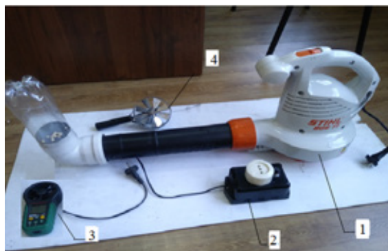
Рис. 12. Экспериментальное оборудование для определения конечной скорости (в лаборатории “Сельскохозяйственная техника и технологии” Казахского научно-исследовательского института механизации и электрификации сельского хозяйства, Алматы, Казахстан): 11– вентилятор, 2 – регулятор расхода воздуха, 3 – цифровой анемометр ветряка, 4 – механический анемометр ветряка.
