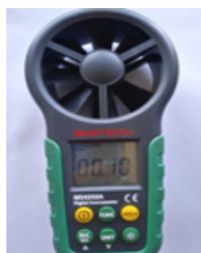
Рис. 5. Ручной цифровой анемометр MASTECH® MS6252A, измеритель скорости ветра и тестер расхода воздуха.
