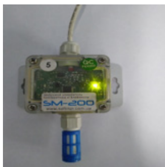
Рис. 8. Датчик температуры и влажности SOFTRON® SM-200.
