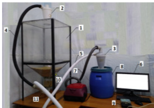
Рис. 2. Экспериментальное оборудование для хранения зерна (сои) с активной вентиляцией [Fig. 2. Experimental equipment for grain (soybean) storage with active ventilation].
