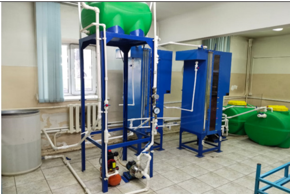
Сур.2. Тәжірибелік баяу құмды сүзгі қондырғысы. [Fig.2. experimental slow filter unit].
