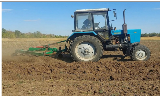
Рис. 2. Фрагмент производственных испытаний четырехкорпусного навесного плуга с ромбовидными рабочими органами [Fig. 2. Fragment of production tests of a four-body mounted plow with diamond-shaped working bodies]
