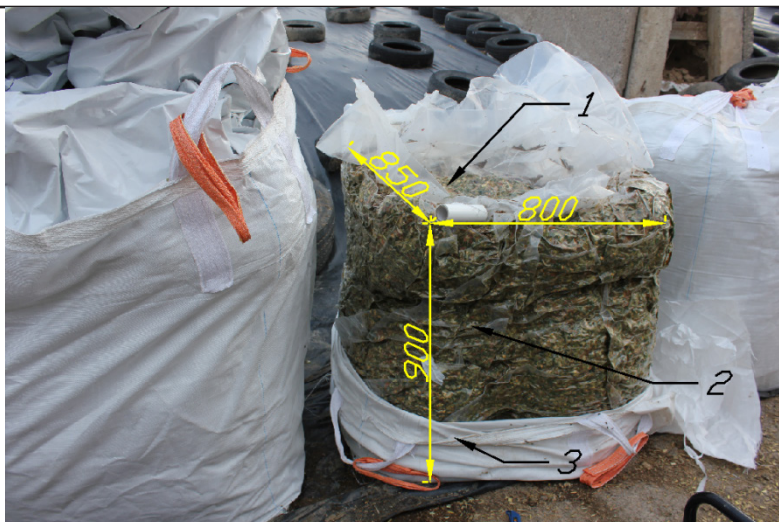
1 – полиэтиленовая пленка, 2 – зеленая измельченная масса, 3 – грузонесущий мешок типа «Биг-Бег»
