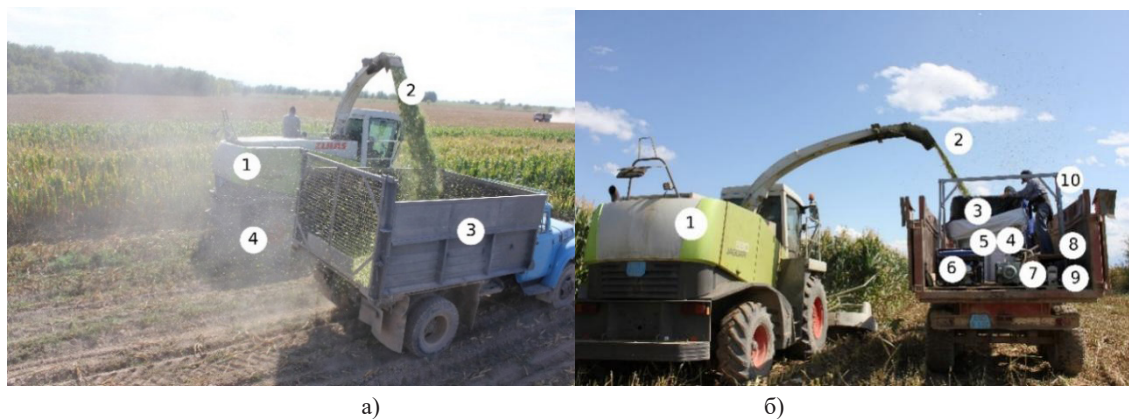
а) перевозка традиционным способом: 1 – кормоуборочный комбайн, 2 – измельченная зеленая масса, 3 – транспортное средство ЗИЛ 130,
