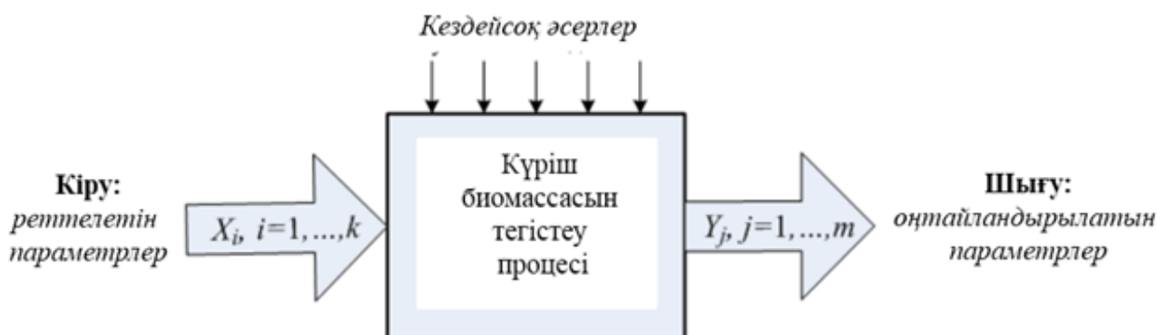
Сур. 3. Күріш биомассасын тегістеу процесінің моделі
