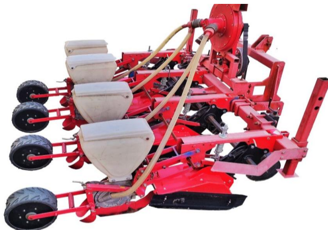
Рисунок 2 - Экспериментальный образец сеялки точного высева.
