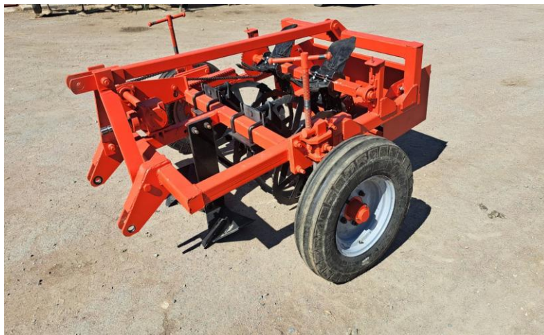
Рисунок 4 - Экспериментальный образец комбинированного выкапывающего устройства
