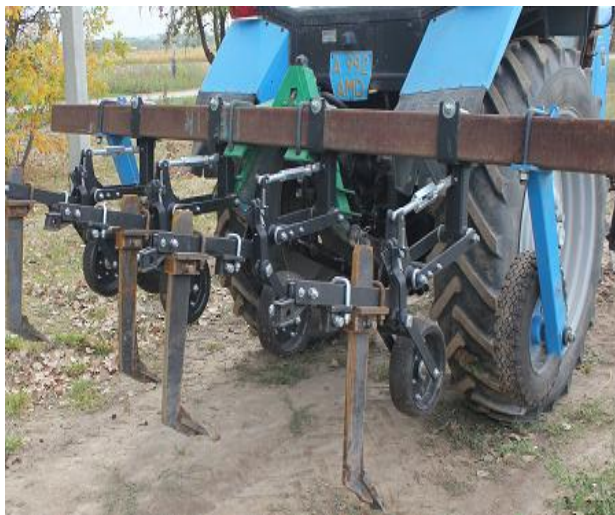
Рисунок 3 - Экспериментальный образец универсального культиватора с рабочими органами для глубокого рыхления междурядий.
